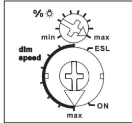
**Mit dem %-Drehschalter** kann die Mindesthelligkeit (voll abgedimmt) eingestellt werden, z. B. für dimmbare Energiesparlampen.
