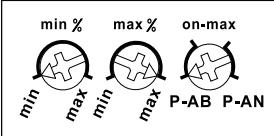
**Mit dem linken %-Drehschalter** kann die Mindesthelligkeit (voll abgedimmt) eingestellt werden.
