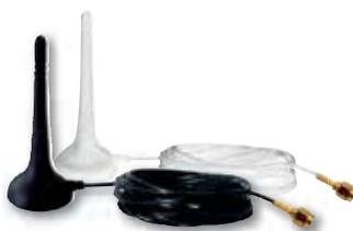
Die kleine beiliegende Funkantenne der Funk-Antennenmodule FAM14 kann für die Einleitung der Funk-signale in Metall-Schaltschränke durch eine größere Antenne ausgetauscht werden. Diese wird mit einem Magnetfuß extern angebracht. Das Kabel wird nach innen bis zu dem FAM14 geführt. Höhe der FA250 nur 10 cm, der FA200 59 cm.
