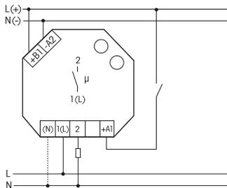
Bei angeschlossenem N ist die Kontaktschaltung im Nulldurchgang aktiv.
