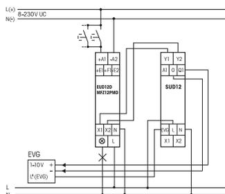
In dieser Schaltungsart können, in Verbindung mit einem Universal-Dimmschalter EUD12D bzw. MFZ12PMD elektronische Vorschaltgeräte und Trafos mit einer 1-10V-Schnittstelle bis zu 40 mA Gesamt-Steuerstrom angesteuert werden.
