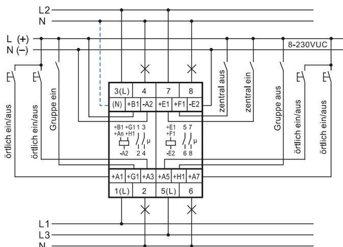
Bei angeschlossenem N ist bei den Kontakten 1-2, 3-4 und 5-6 die Kontaktschaltung im Nulldurchgang aktiv.
