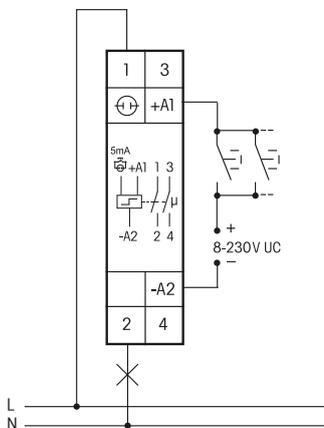
**oder** Steuerspannung 230 V mit Glimmlampenstrom bis 5 mA
