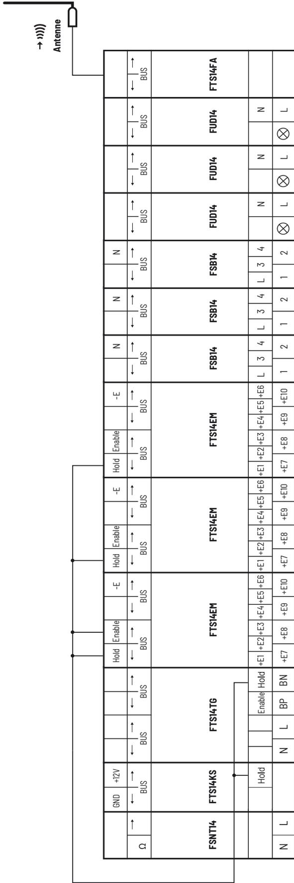
Am letzten Bus-Teilnehmer muss der dem FTS14KS beiliegende zweite Abschlusswiderstand aufgesteckt werden. Jedes FTS14FA erzeugt die Funktelegramme von bis zu 5 Taster-Eingabemodulen FTS14EM und bis zu 3 Taster-Gateways FTS14TG.
