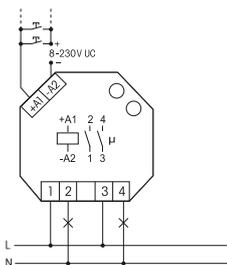
Die Elektronik hat keine eigene Stromversorgung und daher in beiden Kontaktstellungen keinen Stromverbrauch. Lediglich während des kurzen Steuerimpulses von nur 0,2 Sekunden fließt der Steuerstrom, welcher den Mikrocontroller aktiviert, diesen den letzten Schaltzustand aus seinem nichtflüchtigen Speicher lesen lässt, das bistabile Relais dementsprechend in die entgegengesetzte Richtung schaltet und den neuen Schaltzustand in den Speicher zurückschreibt.
