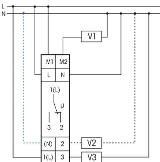
Bei angeschlossenem N ist die Kontaktschaltung im Nulldurchgang aktiv.
