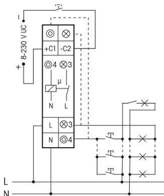
4-Leiter-Schaltung, mit Dachbodenbeleuchtung, nachschaltbar.
