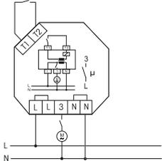
Mit einem Fensterkontakt (Schließer bei offenem Fenster) wird die Stromversorgung eines Dunstabzuges zugeschaltet, damit dieser nur bei geöffnetem Fenster eingeschaltet werden kann.
