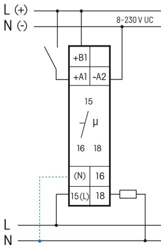
Bei angeschlossenem N ist die Kontaktschaltung im Nulldurchgang aktiv.
