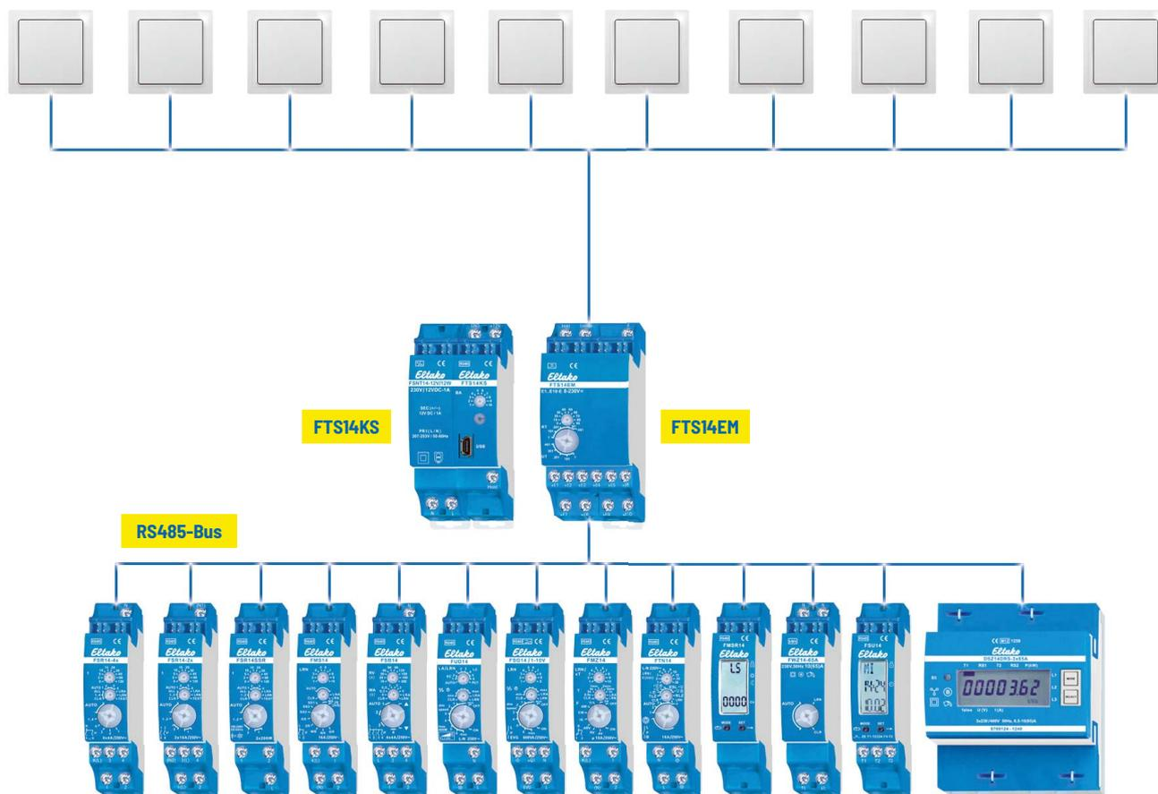
Alle Möglichkeiten lassen sich beliebig kombinieren: FTS14EM mit Aktoren, mit dem Funkantennenmodul FAM14, mit dem Taster-Funkausgabemodul FTS14FA und dem Taster-Gateway FTS14TG für die Verbindung mit Taster-Kopplern FTS61BTK.
