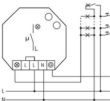
4-Leiter-Schaltung, mit Dachbodenbeleuchtung, nachschaltbar.
