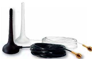
Die kleine beiliegende Funkantenne der Funk-Antennenmodule FAM14 kann für die Einleitung der Funksignale in Metall-Schalschränke durch eine größere Antenne ausgetauscht werden. Diese wird mit einem Magnetfuß extern angebracht. Das Kabel wird nach innen bis zu dem FAM14 geführt. Höhe der FA250 nur 10 cm, der FA200 59 cm.
