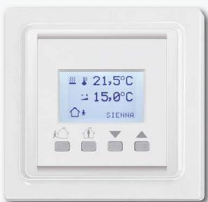
**Termoregolatore powerline con display, bianco, 50x50 mm. Con contatto potenzialmente libero 3 A/250 V per il controllo riscaldamento e raffreddamento. Display illuminato. Assorbimento in stand-by solo 0,4 Watt.**
