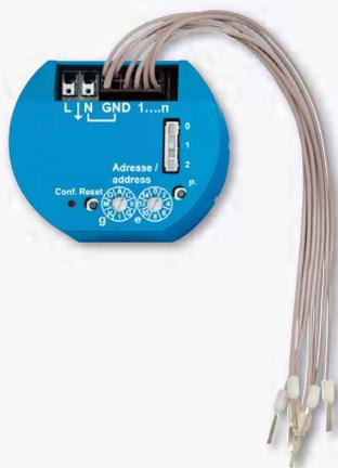
**Comando powerline a 8 canali. 54x43 mm, 25 mm di profondità, per il montaggio su scatole rotonde. 8 ingressi di comando a bassa tensione interna. Assorbimento in stand-by solo 0,5 Watt. Per il controllo da un altro posto.**
