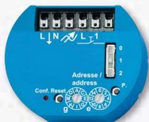
**Attuatore powerline dimmer con 1 canale. 54x43 mm, 25 mm di profondità, per il montaggio su scatole rotonde. Dimmer a taglio di fase in salita per carichi fino a 300 W con  $\cos \phi = 1$  e 150 W con  $\cos \phi = 0,6$ . Trasformatori elettronici fino a 150 W. Ingresso di comando 230 V. Assorbimento in standby 0,5 Watt. Per il controllo sul posto.**
