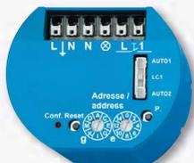
**Attuatore powerline dimmer universale. 53x43 mm, 40 mm di profondità, per il montaggio su scatole rotonde. Power MOSFET fino a 300W. Riconoscimento automatico della lampada. Ingresso di comando 230V. Assorbimento in standby 0,6 Watt. Per il controllo sul posto.**
