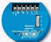
**Attuatore powerline luce scale con 1 canale. 54x43 mm, 25 mm di profondità, per il montaggio su scatole rotonde. Ritardo alla diseccitazione da 1 a 120 minuti. Preavviso di spegnimento impostabile. Contatto 1 NA 10 A/250 V AC, lampade ad incandescenza 2000 Watt. Ingresso di comando 230 V. Assorbimento in stand-by solo 0,5 Watt. Per il controllo sul posto.**
