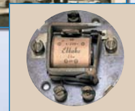
Uno de los primeros telerruptores
