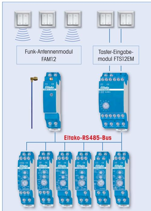
**Alle RS485-Bus-Aktoren für den Reiheneinbau, welche seither nur über Funk-Signale gesteuert wurden, können Sie mit Hilfe des Taster-Eingabemoduls FTS12EM nun auch mit konventionellen Tastern ansteuern.**
