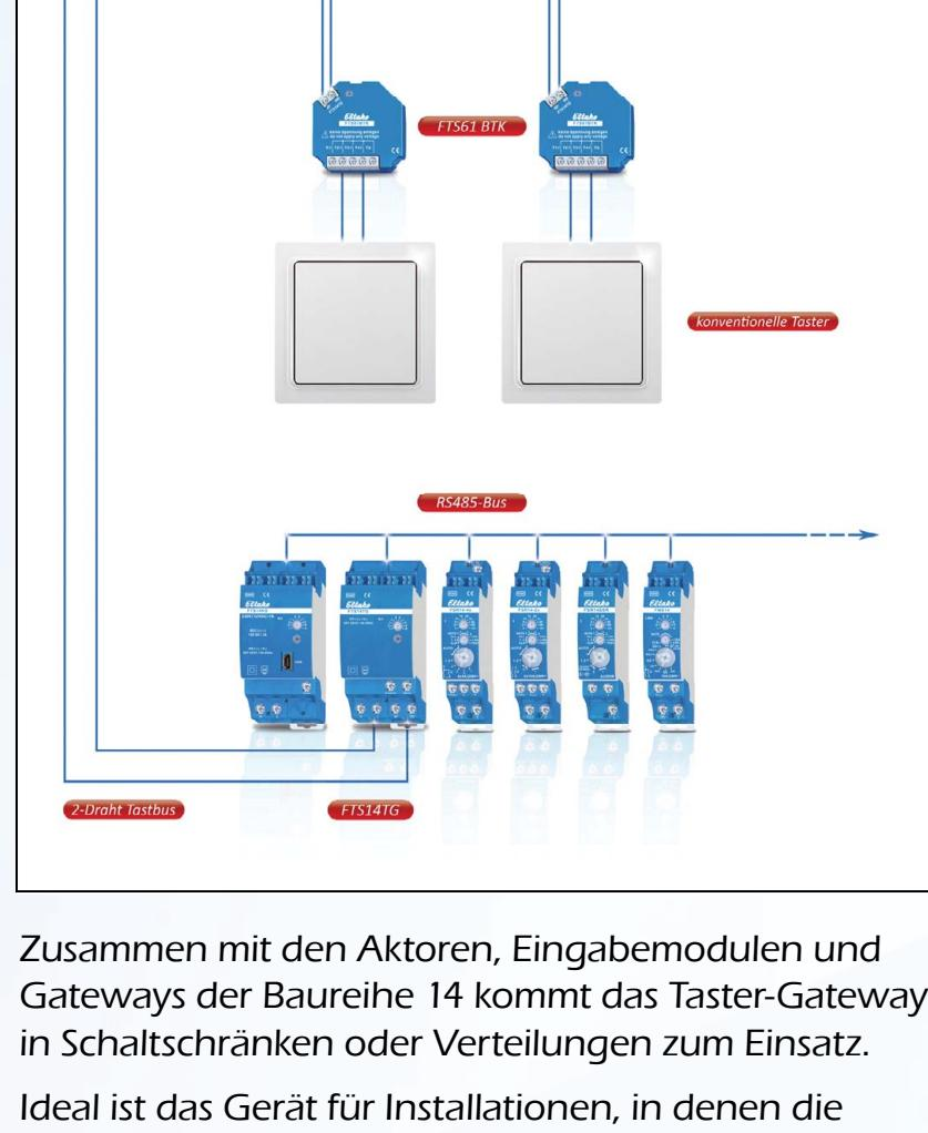
Zusammen mit den Aktoren, Eingabemodulen und Gateways der Baureihe 14 kommt das Taster-Gateway in Schaltschränken oder Verteilungen zum Einsatz.
