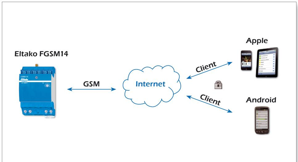
Jetzt auch mit Push-Funktion. Damit lassen sich Störungsmeldungen aktiv auf dem Smartphone darstellen. Ausgelöst z. B. von Rauchwarnmeldern, Wassersensoren oder Fensterkontakte.
