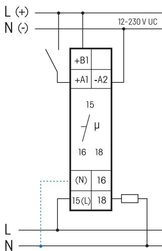
Bei angeschlossenem N ist die Kontaktierung im Nulldurchgang aktiv.
