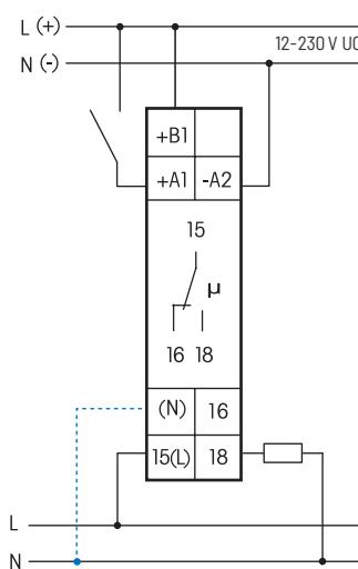
Bei angeschlossenem N ist die Kontaktenschaltung im Nulldurchgang aktiv.
