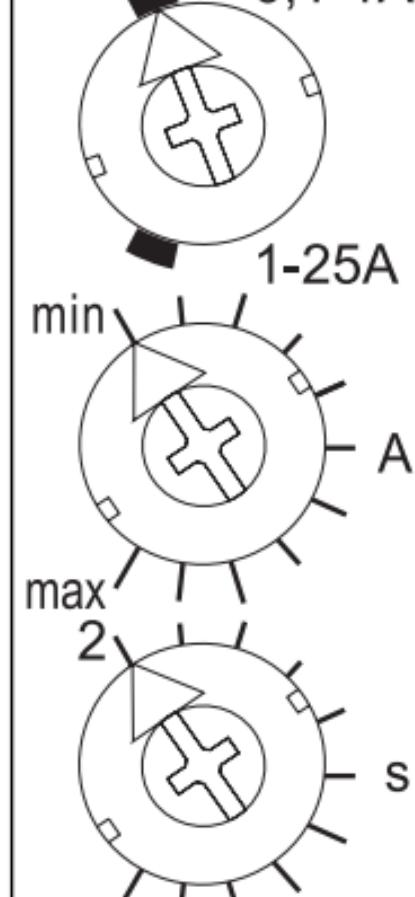
Der Einstellbereich ist umschaltbar zwischen 0,1 bis 1,0A AC und 1,0 bis 25A AC.
