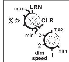
Mit dem % ⚡-Drehschalter kann die Mindesthelligkeit (voll abgedimmt) eingestellt werden.
