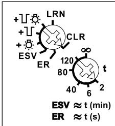
**Mit dem oberen Drehschalter** werden in der Stellung LRN bis zu 35 Funktaster zugeordnet, davon ein oder mehrere Zentralsteuerungs-Taster. Außerdem Funk-Fenster-Türkontakte mit der Funktion Schließer oder Öffner bei geöffnetem Fenster, Funk-Außen-Helligkeitssensoren FAH und Funk-Bewegungsmelder FBH. Danach wird damit die gewünschte Funktion dieses Stromstoß-Schaltrelais gewählt:
