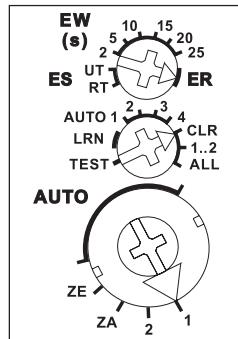
**Mit dem oberen Drehschalter** wird die Funktion der 2 Kanäle gemeinsam als Stromstoßschalter mit Universaltaster (**ES-UT**), als Stromstoßschalter mit Richtungsfaster (**ES-RT**), als Einschaltwischer (**EW**) oder als Relais (**ER**) definiert. In der Funktion ES können Zentralsteuerbefehle Ein/Aus eingelernt werden. In der Funktion EW kann die Wischzeit zwischen 2 und 25 Sekunden eingestellt werden.
