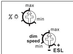
**Mit dem % -Drehschalter** kann die Mindesthelligkeit (voll abgedimmt) eingestellt werden, z. B. für dimmbare Energiesparlampen.
