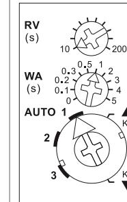
**AUTO 1** = In dieser Stellung des unteren Drehschalters ist die örtliche **Komfortwendefunktion für Jalousien eingeschaltet**. Bei der örtlichen Steuerung mit einem Taster an A3+A4 (mit einer Brücke verbinden) oder einem Doppel-taster an A5/A6 bewirkt ein Doppelimpuls das langsame Drehen in die Gegenrichtung, welches mit einem weiteren Impuls gestoppt wird.
