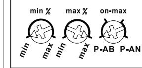
**Mit dem linken %-Drehschalter** kann die Mindesthelligkeit (voll abgedimmt) eingestellt werden.
