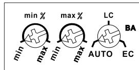
**Mit dem linken %-Drehschalter** kann die Mindesthelligkeit (voll abgedimmt) eingestellt werden.
